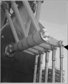
Articulación de palancas del control (lubricar)
